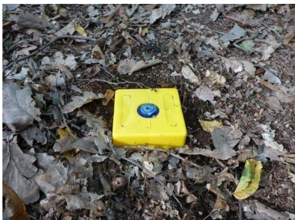
Roh DP fixovaný geodetickým mezníkem
