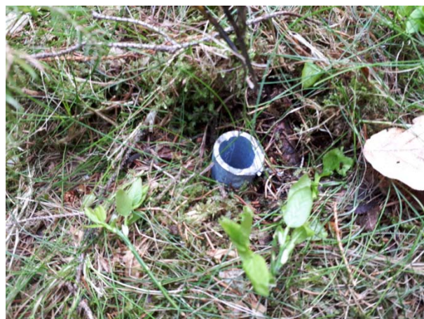
Fotobod fixovaný ocelovou trubkou
