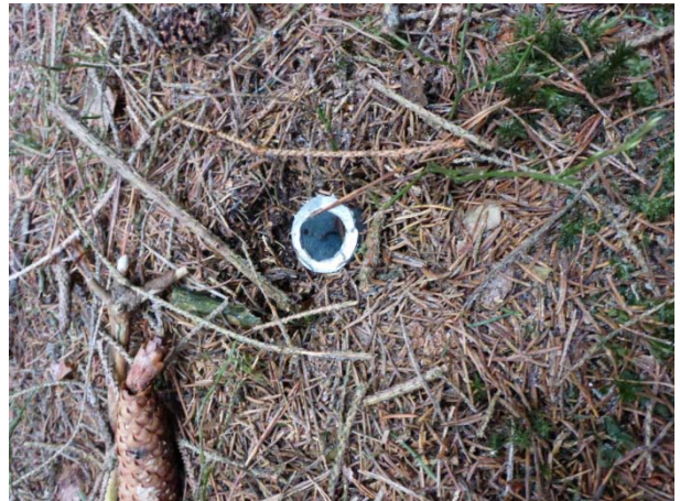
Fotobod fixovaný ocelovou trubkou
