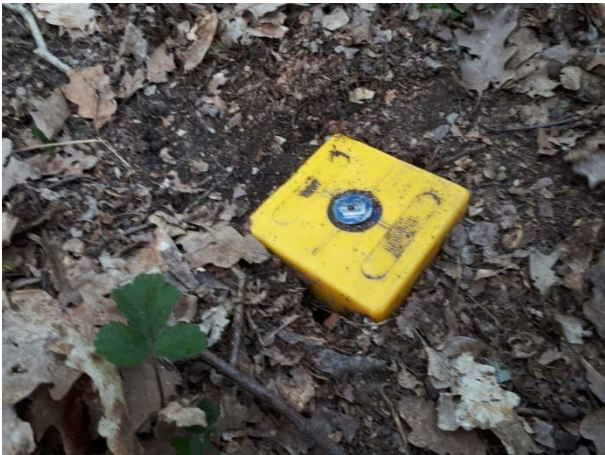
Roh DP fixovaný geodetickým mezníkem
