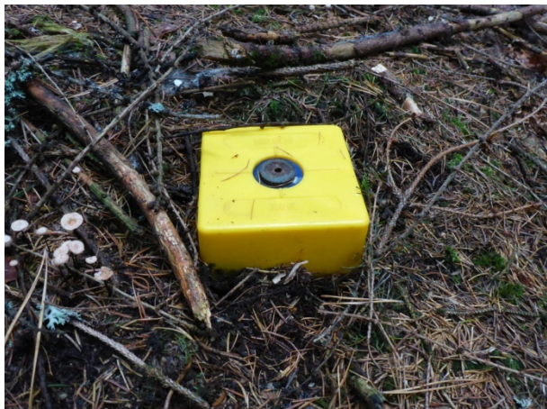
Roh DP fixovaný geodetickým mezníkem
