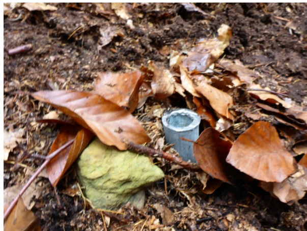
Fotobod fixovaný ocelovou trubkou
