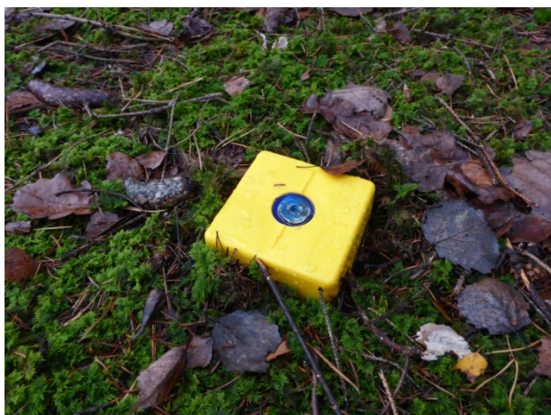
Roh DP fixovaný geodetickým mezníkem
