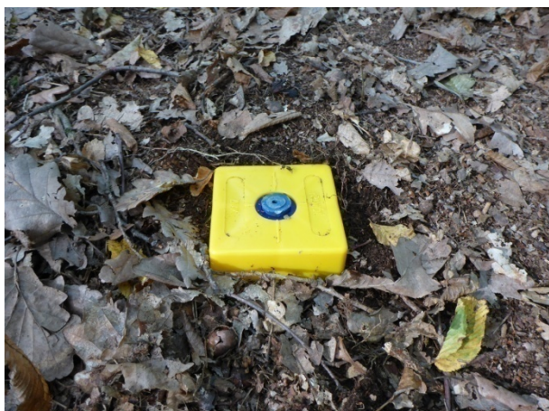
Roh DP fixovaný geodetickým mezníkem
