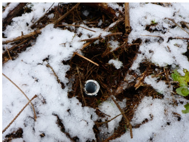
Fotobod fixovaný ocelovou trubkou
